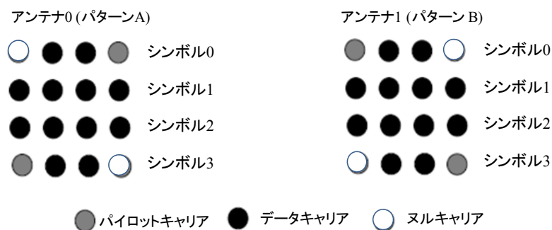
図 4.9.1.1-2 IAP モードにおける 2 送信アンテナの場合のクラスタ構成(モード 2 のみ)
